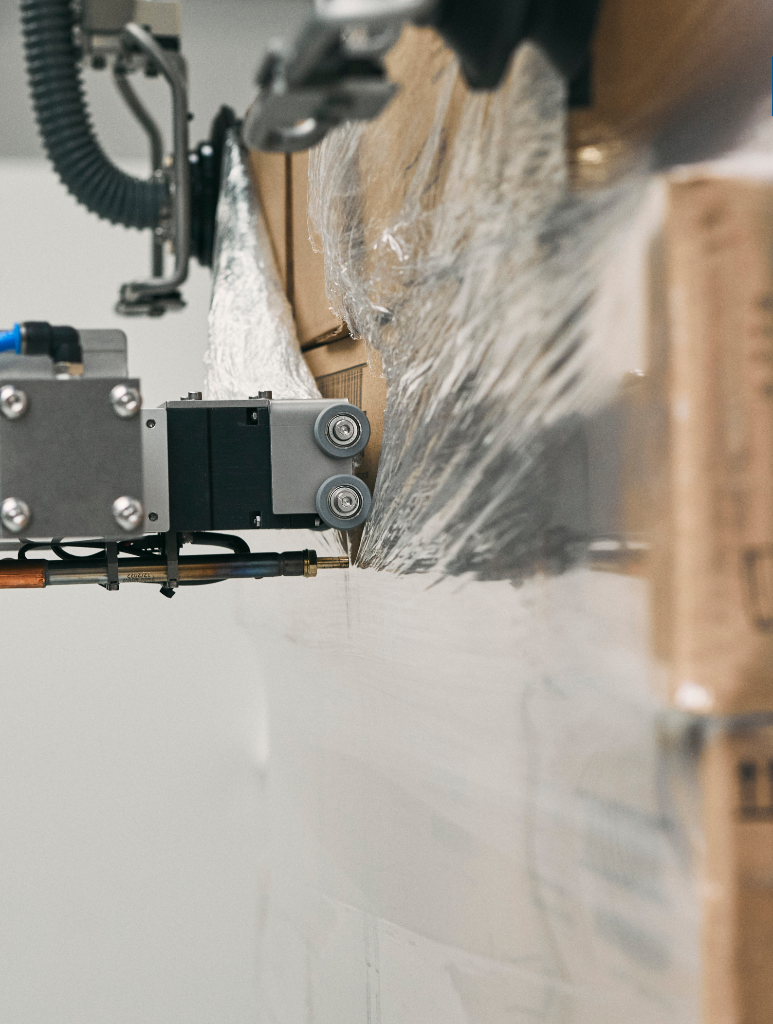
Automatisches Schneiden und Entfernen der Stretchfolie ohne Beschädigung des Produktes
